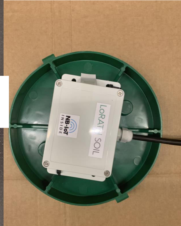
Datalogger in der Berechnungsbox mit Kabelbinder fixiert.
